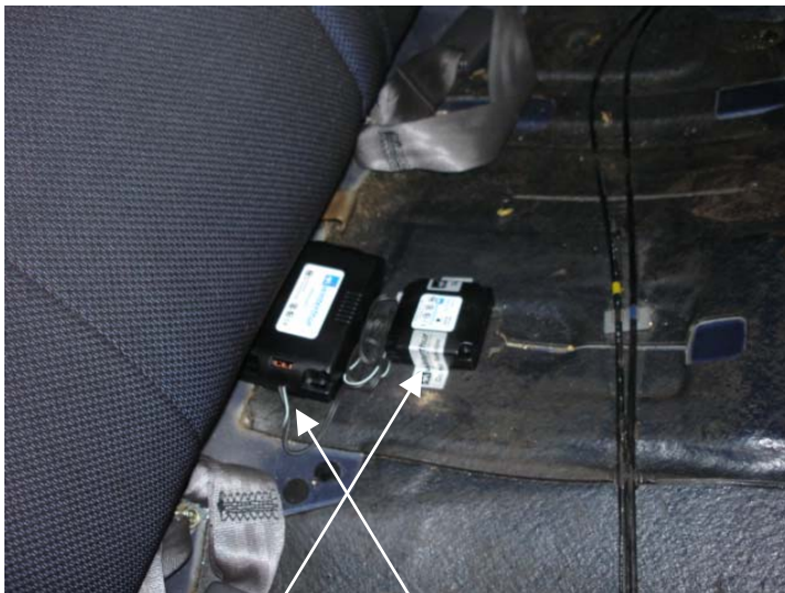
Abbildung 1: Crash Recorder und Batterypack
